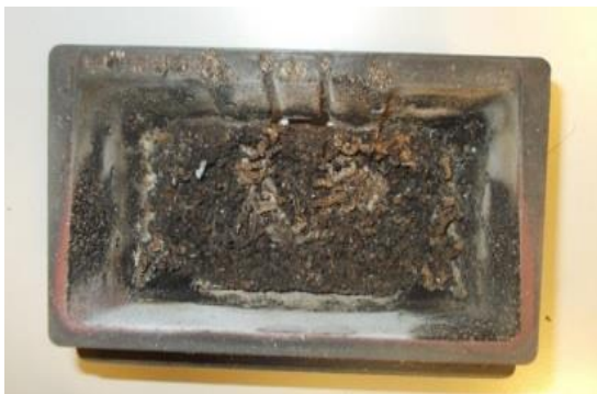
RUSZT KTÓRY WYMAGA CZYSZCZENIA
