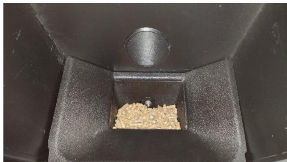
Lekko zasypany ruszt
