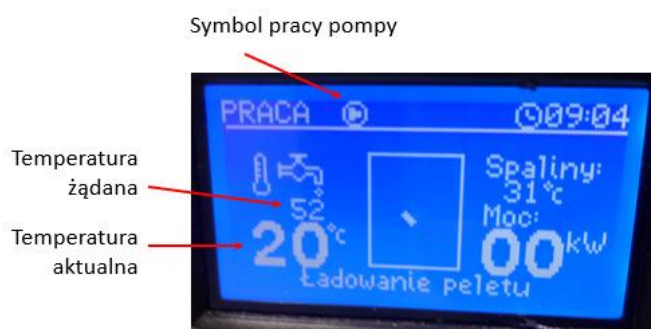
Ponowne rozpalanie kotła
