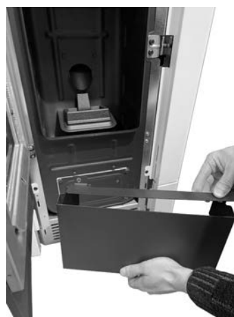
Fig. 36 - Usunąć przedni panel i zatyczkę
