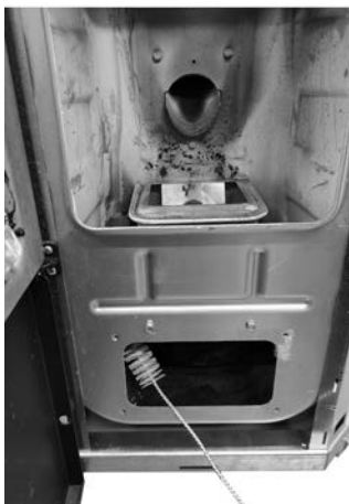
Fig. 76 - Wyczyścić szczotką do rur
